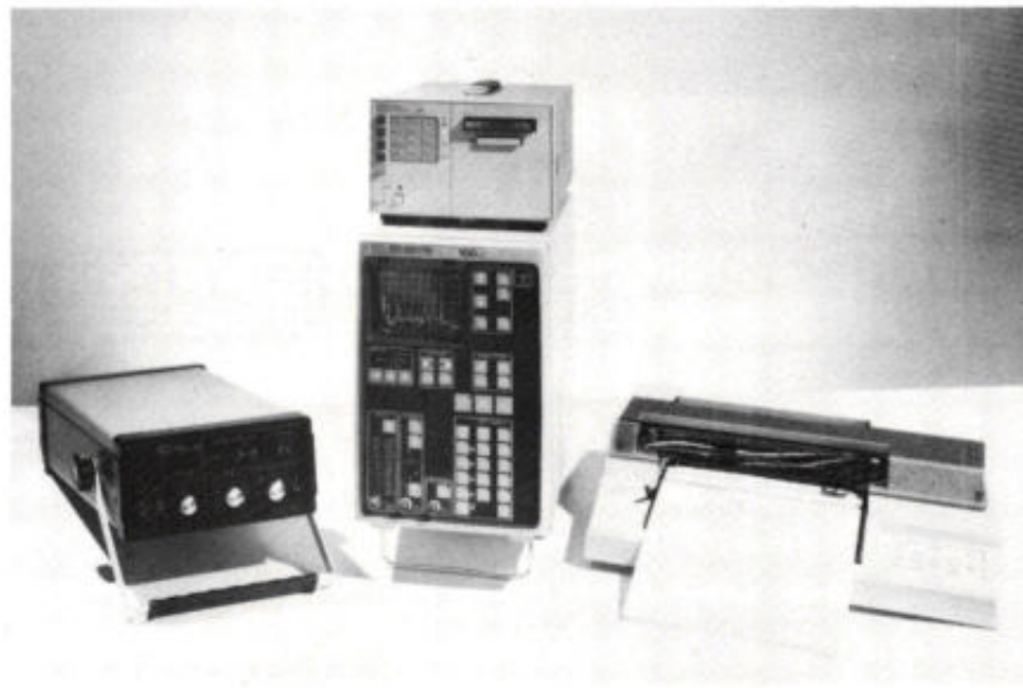
Afb. 5. Modulair FFT-analysesysteem van Nicolet, bestaande uit de analysator 100A-10, een massageheugen, een digitale tweekleurenplotter en een tracking adapter (links).
