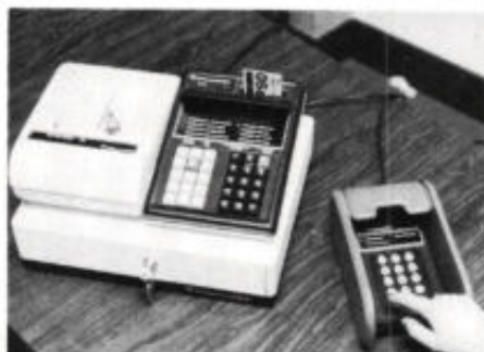
Afb. 1. Deze terminal, waarvan Flonic Schlumberger er 250 heeft gefabriceerd, wordt gebruikt bij de eerste grootschalige praktijkproef in Lyon. Rechts op de foto het toetsenbord waarop de klant zijn geheime code moet intikken.
