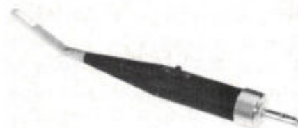
Proefmodel van een kortstthermometersonde.
