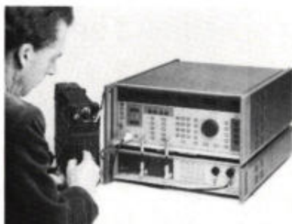
Afb. 7. Signaalgenerator 9087 van Racal-Dana met interface-eenheid.
