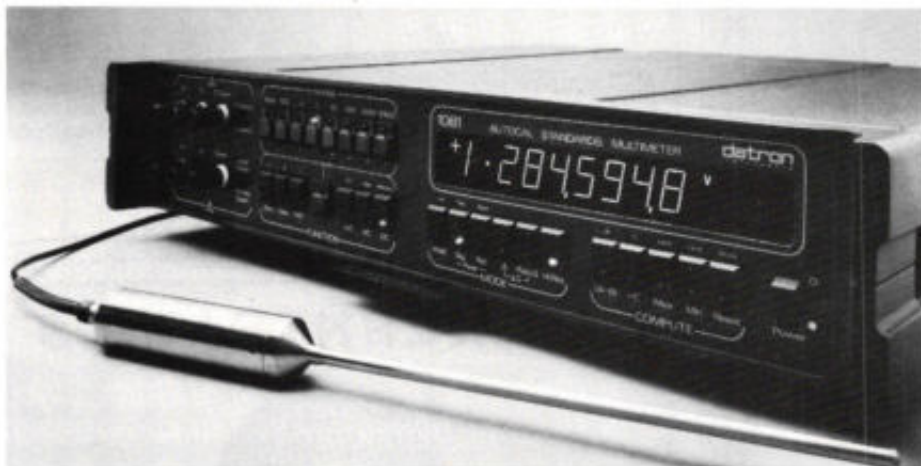
Afb. 2. 1081 Autocal van Datron met op de voorgrond de als accessoire verkrijgbare platinum resistance temperatuursonde.
